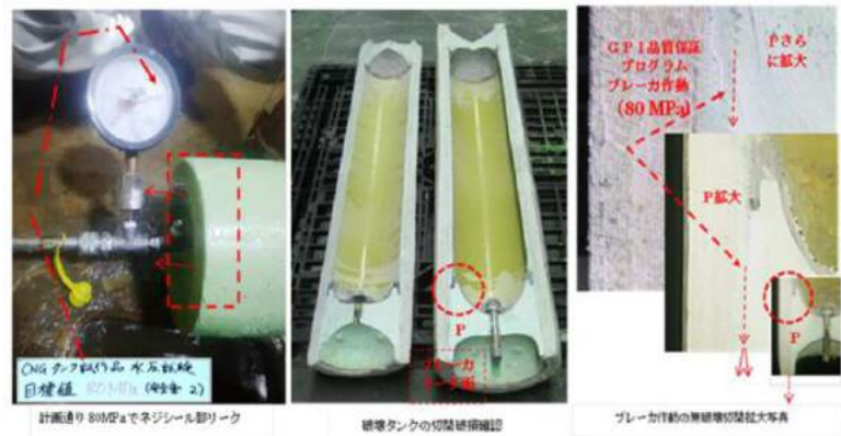
写真1: 液化・高圧ガス併用2重タンクの組立 写真2: 80MPaブレーカ性能試験結果と試験後のタンク切開検査の異常なしの確認
