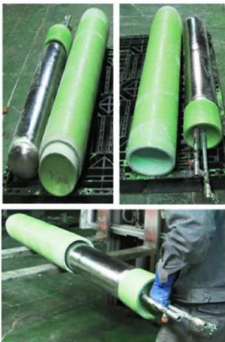
写真1: 液化・高圧ガス併用2重タンクの組立 写真2: 80MPaブレーカ性能試験結果と試験後のタンク切開検査の異常なしの確認
